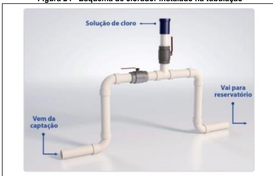
Figura 24 - Esquema de clorador instalado na tubulação
