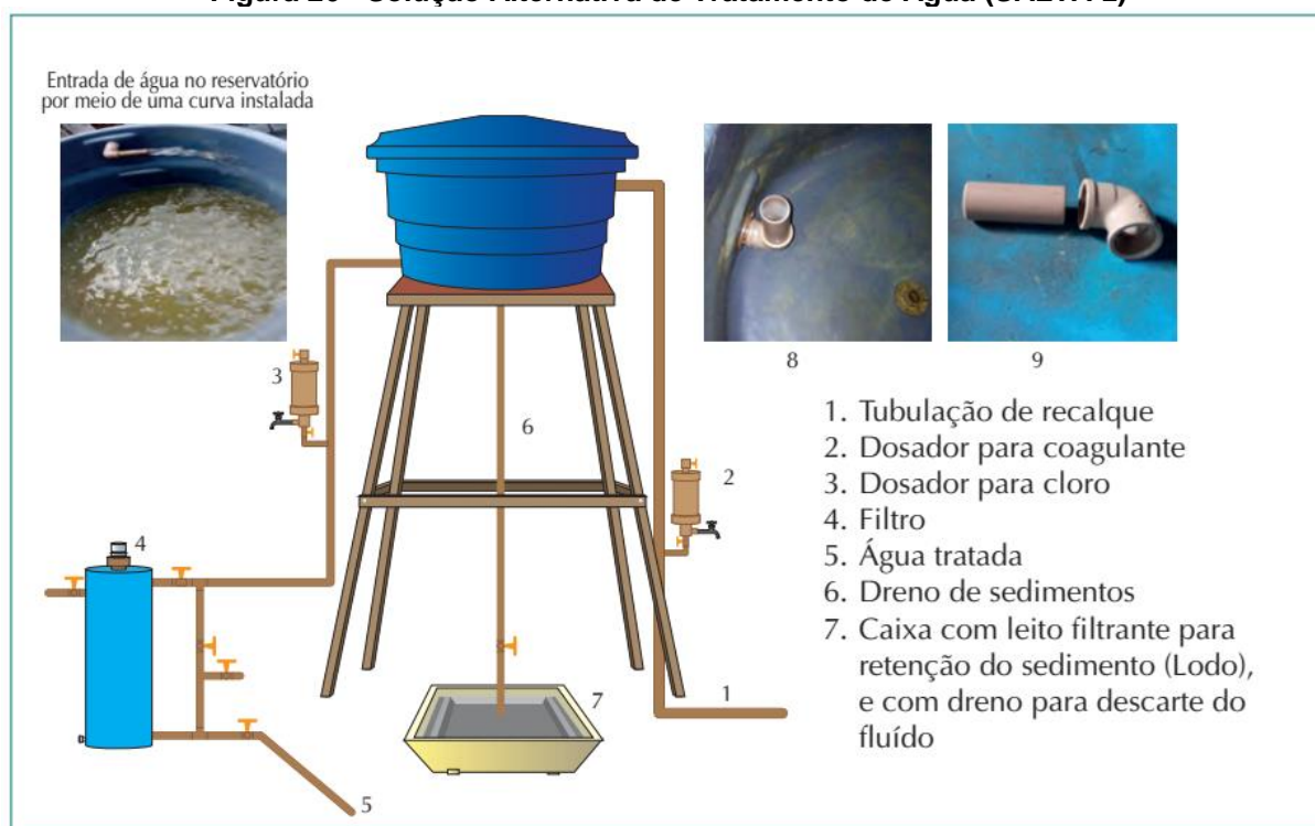
Figura 26 - Solução Alternativa de Tratamento de Água (SALTA-z)
