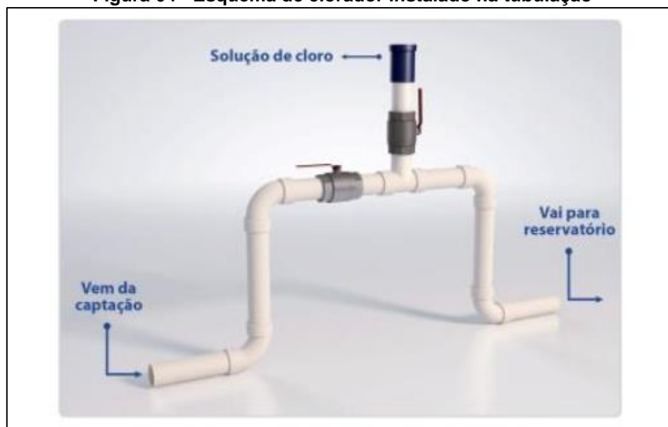
Figura 64 - Esquema de clorador instalado na tubulação
